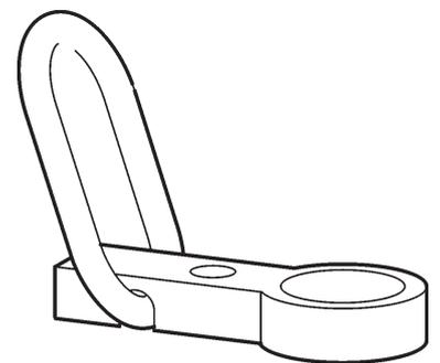
**1 Aufhängevorrichtung zum Heben von Betonelementen**
