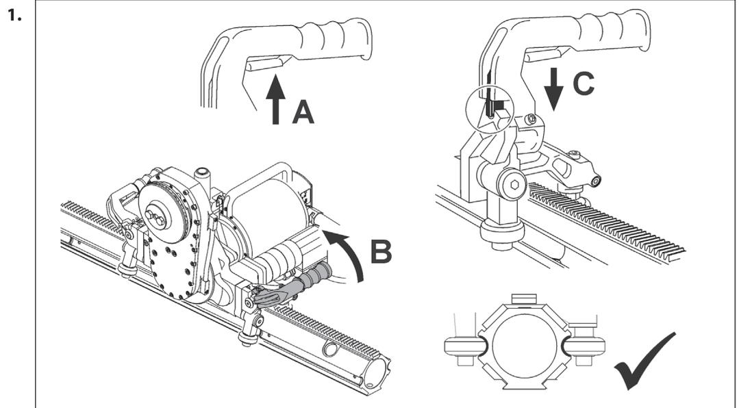
2. Si los asideros no encastran o si la cortadora queda demasiado floja sobre el riel guía: ajustar los rodillos guía.
