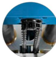
Princípio de guia de duas colunas com acionamento por corrente
